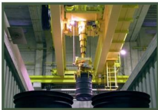
Figuur 5. De vaten worden gestapeld met behulp van een rolbrug.
